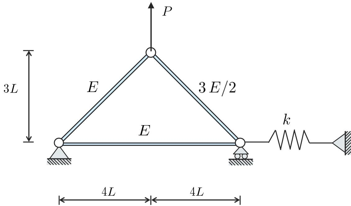
har elasticitetsmodulen  $E$  medan den tredje har elasticitetsmodul  $3E/2$ . Bestäm största tillåtna kraft  $P$  så att utknäckning undviks med en tvåfaldig säkerhet. Försumma egentyngder. Fjäderstyrkgheten  $k = \pi d^2 E / (40 L)$
