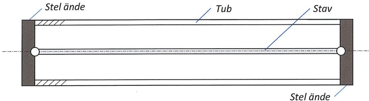
Data för tuben: Längd –  $L$ , Elasticitetsmodul –  $E$ , Tvärsnittsarea –  $10A$ , Längdutvidgningskoefficient –  $2\alpha$
