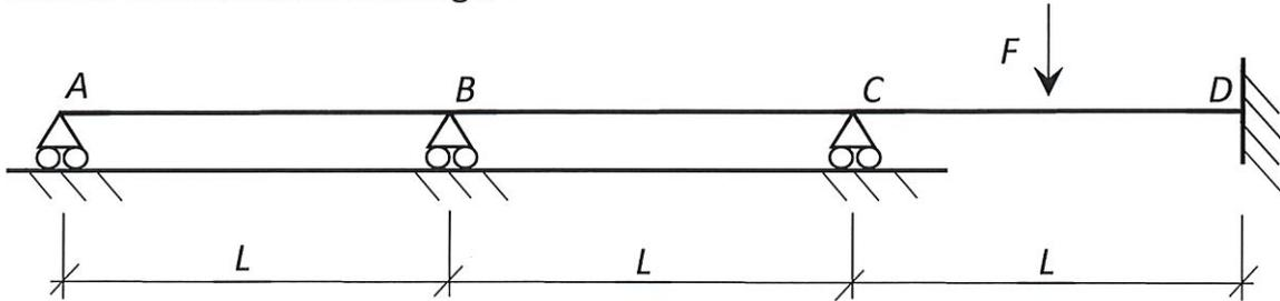
Använd elementarfall, jämvikts samband (balkdelarna) med moment är lika över momentfria stöd) och vinkelkompatibilitet över stöd
