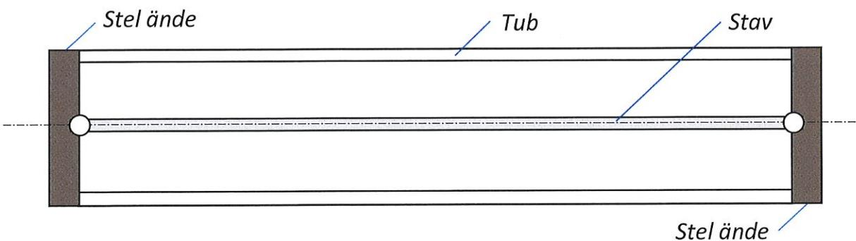
Data för tuben: Längd –  $L$ , Elasticitetsmodul –  $E$ , Tvärsnittsarea –  $10A$ , Längdutvidgningskoefficient -  $2\alpha$
