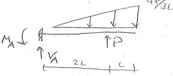
Använd snittmetoden för ta fram T(x) och M(x)
