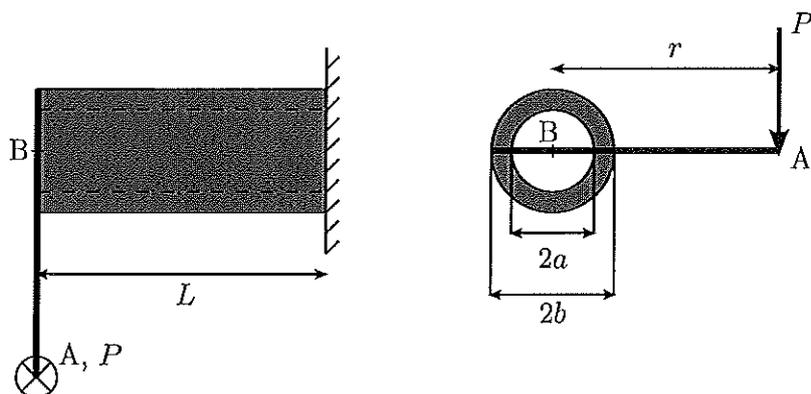
Ett tjockväggigt rör med längd  $L$ , innerradie  $a$  och ytterradie  $b$  är fast inspänt i en vägg. En *stål* stång är fastsvetsad i andra änden enligt figur. En kraft  $P$  appliceras i stångens yttre ände A (vilken befinner sig på längden  $r$  från rörets mittlinje). Röret har elasticitetsmodul  $E$  och skjuvmodul  $G$ . Vänstra figuren visar röret sett uppifrån, högra figuren röret sett rakt framifrån, in mot väggen.
