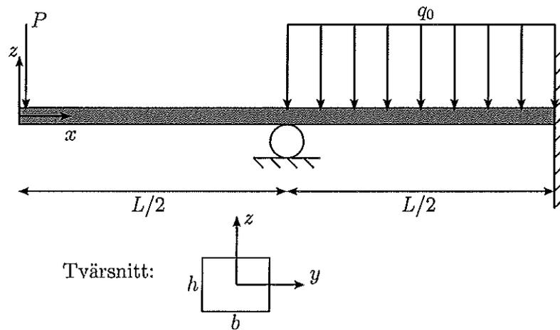
En balk med längd  $L$ , elasticitetsmodul  $E$  och rektangulärt tvärsnitt är fast inspänd i en vägg och vilar på ett rullstöd enligt figur. Balken belastas av en utbredd last  $q_0 = 8P/L$  och en punktkraft  $P$  enligt figur (kraften  $P$  verkar i själva verket längst ut på balken).
