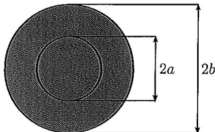
Ett elastisk plugg med cirkulärt tvärsnitt med radie  $a$  förs in i ett elastiskt tjockväggigt rör med innerradie  $a$  och ytterradie  $b$ . Pluggen har temperaturutvidgningskoefficient  $\alpha$  och båda kroppar har elasticitetsmodul  $E$  och tvärkontraktionstal  $\nu$ . Plant spänningstillstånd antas råda. Pluggen värms upp så att temperaturförändringen blir  $\Delta T$ . Röret antas inte ändra temperatur.
