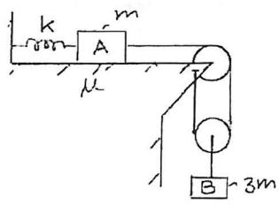
Systemet i figuren består av två kroppar A och B med massor  $m$  och  $3m$  förenade via lätta linor och trissor. En fjäder  $k$  fäster i A enligt figur. Det rader friktion,  $\mu$ , mellan A och underlaget. Systemet släpps från vila då fjädern är ospänd. Bestäm A:s största hastighet därefter (pabörjad rörelse förutsätts). (5 poäng)
