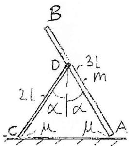
En balk AB med massa  $m$  och längd  $3L$  står på ett strävt horisontellt underlag. Balken stöds av en masslös stång CD med längd  $2L$ . Stången fäster i balken i D via en friktionsfri led. Vad är största möjliga vinkel  $\alpha$  för jämvikt om den statiska friktionskoefficienten  $\mu = 0.5$  vid golvkontakterna i A och C? (5 poäng)
