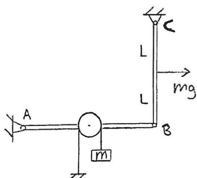
En struktur är sammansatt av två *masslösa* stänger, AB och BC, med längder  $2L$ . Mitt på stång AB är en masslös trissa fäst. En lina löper över trissan, där ena änden uppbär en massa  $m$ . Stängerna är förbundna med friktionsfria leder i A, B och C.
