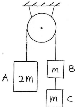
Tre kroppar A, B och C är sammankopplade med linor enligt figur. Linan mellan A och B löper över en lätt, friktionsfri trissa. Delkropparna rör sig från början med konstant fart  $v$ : A nedåt, B och C uppåt (situation 1). Plötsligt brister linan mellan B och C, och A accelererar nedåt (situation 2). Bestäm linkraften verkande på A enligt
