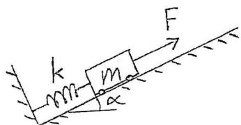
En kropp, massa  $m$ , är förbunden med en fjäder, styrka  $k = mg/L$ . Kroppen kan rulla förlustfritt längs ett lutande plan, vinkel  $\alpha$ . En konstant kraft  $F = 4mg$  börjar verka då kroppen är i vila och fjädern är ospänd. Bestäm då kroppen förflyttats sträckan  $L$  uppför planet
