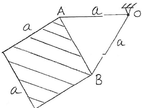
En kvadratisk skiva med sidan  $a$  har massan  $m$ . I skivan fäster två linor, AO och BO, båda med längden  $a$ . Linorna fäster i sin tur i en fix punkt O. Systemet, som kan pendla friktionsfritt i ett vertikalplan, släpps från vila i det läge som visas i figuren (AO horisontell). Bestäm dragkrafterna i respektive lina i det ögonblick då BO är vertikal. (5 poäng)
