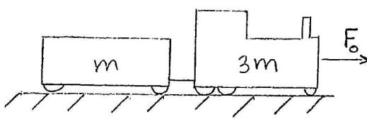
Ett lättörat tågset (lok med massa  $3m$  och vagn med massa  $m$ ) åker med farten  $v_0$  då en konstant kraft  $F_0$  börjar verka på loket enligt figur.
