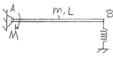
En balk, massa  $m$  och längd  $L$ , är friktionsfritt ledad i A och förbunden med en fjäder i B. Ett rent moment  $M$  paläggs systemet för att balken skall vara horisontell och i jämvikt. Plötsligt tas momentet  $M$  bort. Bestäm lagerkrafterna verkande på balken i A omedelbart därefter. (5 poäng)
