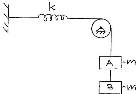
Systemet i figuren består av en fjäder, styvhets  $k$ , och två kroppar A och B med massa  $m$  vardera. Systemet är i vila då plötsligt kropp B lossnar.
