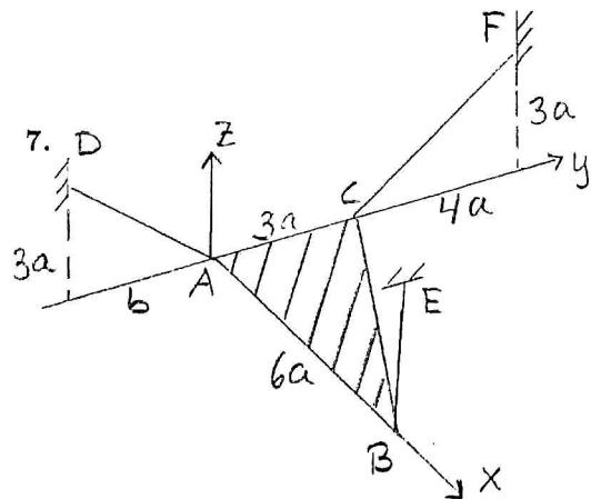
En rätvinklig triangulär skiva ABC med massa  $m$  och kantlängder  $3a$  och  $6a$  ska hängas i horisontellt läge med hjälp av en lina i varje hörn. Linan BE är vertikal och linan CF ligger i  $yz$ -planet där punkten F har koordinaterna  $(0; 7a; 3a)$ . Linan AD ligger också i  $yz$ -planet och punkten D har koordinaterna  $(0; -b; 3a)$ . Bestäm krafterna i de tre linorna och avståndet  $b$ , så att jämvikt är möjlig. (5 poäng)
