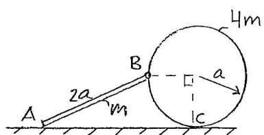
En smal stång AB, massa  $m$  och längd  $2a$ , är förbunden med en cylinder via en led i B. Cylindern har massa  $4m$  och radie  $a$ . Stången och cylindern stöder mot ett strävt underlag i A respektive C. Friktionskoefficienten är lika stor i båda kontaktpunkterna. Hur stor måste denna friktionskoefficient minst vara för att jämvikt skall vara möjlig? (5 poäng)
