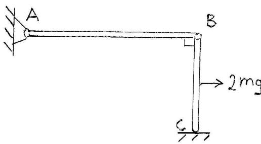
En struktur är sammansatt av två stänger. AB med massa  $2m$  och längd  $2L$ , samt BC med massa  $m$  och längd  $L$ . Strukturen är friktionsfritt ledad i A och B. Vid C vilar strukturen mot ett strävt underlag. En horisontell yttre kraft  $2mg$  verkar mitt på stången BC.
