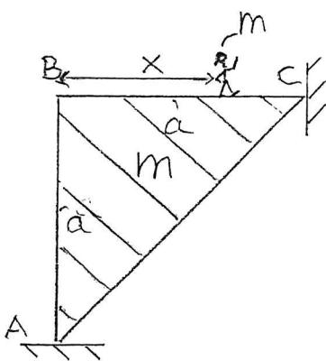
En triangulär kropp ABC med massa  $m$  har höjd och bredd  $a$ . Kontaktytorna är sådana att det är samma friktionskoefficient  $\mu = 1/2$  vid både A och C. En person, massa  $m$ , befinner sig vid  $x$  från hörnet B.
