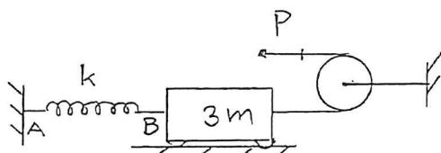
En friktionsfritt rörlig vagn, massa  $3m$ , är förbunden med en fjäder med ospänd längd  $3d$  och styvhet  $k = mg/d$ . En lina fäster i massans högra sida och löper över en trissa enligt figur. En kraft  $P$  verkar i linänden.
