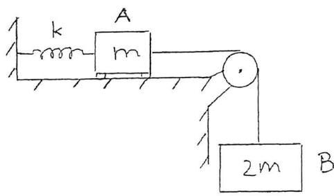
Figuren visar två kroppar (A med massa  $m$  och B med massa  $2m$ ) förenade med en lina. A är kopplad till en fjäder (fjäderkonstant  $k$ ). Systemet släpps från vila då fjädern är ospänd.
