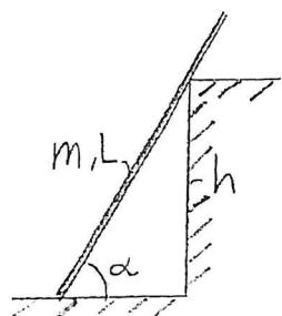
En smal stång, massa  $m$  och längd  $L = 4h/3$ , stöder mot en sträv vägg med höjd  $h$  och ett strävt underlag enligt figur. Friktionskoefficienten är samma i båda kontakterna. Bestäm den statiska friktionskoefficienten om den minsta vinkeln för jämvikt är  $\alpha_{min} = 60^\circ$ .
