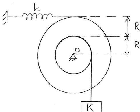
Ett hjul med ytterradien  $2R$  kan rotera utan friktion kring O (masströghetsmoment  $I_O = mR^2$ ). En lina, som är upplindad kring ytterradien, är förbunden med en fjäder med styvhet  $k$ . En annan lina, som är upplindad kring innerradien, är förbunden med en kropp K med massa  $m$ . Systemet släpps från vila då fjädern är ospänd.
