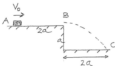
En låda, massa  $m$ , har vid A farten  $v_0$  (okänd). Den glider mot B på ett strävt underlag, friktionskoefficient  $\mu = 1/4$ , varefter den efter flygfärden landar i C (mått enligt figur). Bestäm farten  $v_0$ . (5 poäng)
