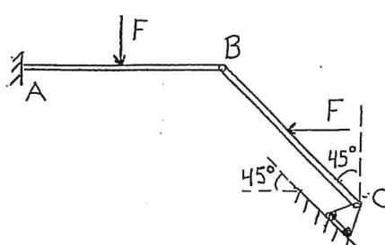
En struktur är sammansatt av två *masslösa* stänger av längd  $2L$  där stängerna är förenade via en friktionsfri led i  $B$ . Mitt på vardera stången appliceras en kraft  $F$  enligt figur.
