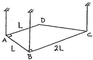
En tunn homogen skiva ABCD (massa  $m$ ) är upphängd i tre lodräta linor som figuren visar, så att skivan är horisontell. Bestäm linkrafterna för jämvikt.
