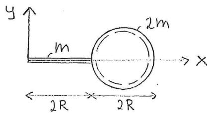
Figuren visar ett sfäriskt skal, massa  $2m$  och radie  $R$ , fäst på en tunnstång, massa  $m$  och längd  $2R$ . Bestäm
