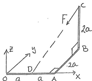
En stång, längd  $6a$ , är böjd enligt figuren där  $OA$  är parallell med  $x$ -axeln,  $AB$  är parallell med  $y$ -axeln och  $BC$  är parallell med  $z$ -axeln. En kraft  $F$  verkar i  $C$  och är riktad längs linjen  $CD$ .
