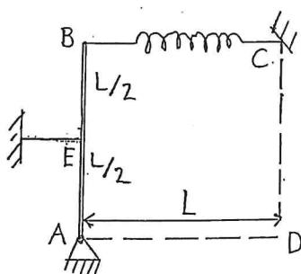
EN VERTIKAL STÅNG AB, MASSA  $m$  OCH LÄNGD  $L$ , ÄR PÅ SIN MITTPUNKT E FÖRBUNDET MED EN HORIZONTELL LINNA. STÅNGEN ÄR ÄVEN FÖRBUNDET MED EN FJÄDER BC FÄST I B. FRÅN BÖRJAN ÄR SYSTEMET I JÄMVIKT DÅ FJÄDERN ÄR HORIZONTELL OCH LINKRAFTEN  $S_E = 2mg$ . PLÖTSLIGT KAPAS LINNA, VAREFTER STÅNGEN PÅBÖRJAR EN ROTATION. BESTÄM STÖDKRAFTERNA I A DÅ
