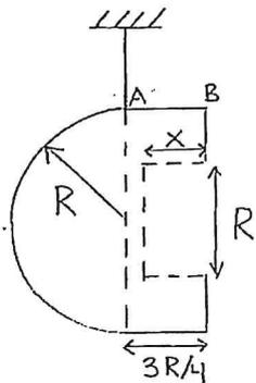
En homogen kropp består av en solid halvsfär, radie  $R$ , och en solid cylinder, längd  $3R/4$ . Man borrar ett hål med radien  $R/2$  ur cylindern. Bestäm hålets djup  $x$  om kroppen skall kunna hänga i en lina vid A, så att AB blir horisontell. (5 poäng)
