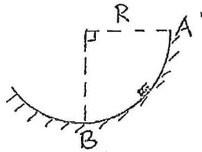
En partikel, massa  $m$ , kan glida inuti en sträv cylinder med friktionskoefficient  $\mu$  och radie  $R$ . Partikeln släpps från vila i läge A. Då partikeln passerar läge B är normalkraften dubbla tyngden;  $N = 2mg$ .
