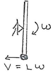
$$T_2 = \frac{1}{2} I_{\text{stång}} \omega^2 + \frac{1}{2} m v^2 \quad \left[ \text{Kan ta } \frac{1}{2} m v^2 = \frac{1}{2} I_{o,m} \omega^2 \right]$$
