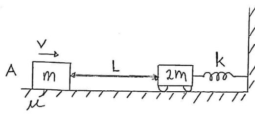
En massa  $m$  har i startläge A farten  $v$  åt höger. Kroppen glider sträckan  $L$  på ett strävt underlag, friktionskoefficient  $\mu$ , varefter kroppen krockar med den vilande massan  $2m$ . Omedelbart efter stöten stannar massan  $m$ , medan massan  $2m$  kommer i förlustfri rullning åt höger. Bestäm i den efterföljande rörelsen den största fjäderkraften (fjäderstyrhet  $k$ ) som någonsin uppkommer. (5 poäng)
