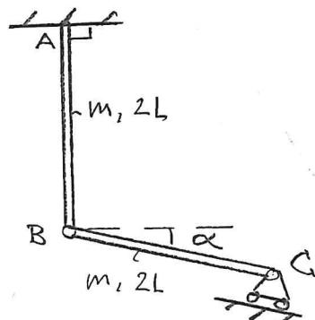
Ett system i jämvikt består av två likadana balkar AB och BC som vardera har längden  $2L$  och massan  $m$ . Balkarna är förenade med en friktionsfri led i B.
