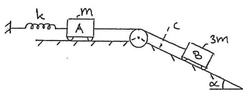
Ett system består av två lättrörliga vagnar, A med massa  $m$  och B med massa  $3m$ , som är förbundna med en lina enligt figur. Kropp B är på ett lutande plan med vinkel  $\alpha$ . Kropp A fäster även i en fjäder, styvhet  $k = mg/d$  där  $d$  är fjäderns ospända längd.
