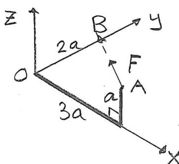
En böjd stång OA, längd  $4a$ , har en del längs med  $x$ -axeln och en del parallell med  $z$ -axeln enligt figur. En kraft med beloppet  $F$  verkar i A och är riktad mot B på  $y$ -axeln.
