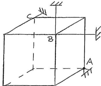
En homogen kub med massa  $m$  sitter i en kulle i hörnet A och hålls i jämvikt med de tre linorna fästade i B och C. Linorna är parallella med kanterna i kuben enligt figuren. Bestäm linkrafterna för jämvikt. (5 poäng)
