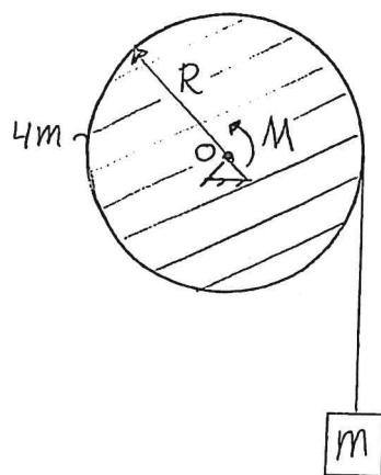
En cylinder, massa  $4m$  och radie  $R$ , kan rotera utan friktion kring O. En massa  $m$  fäster på en lina lindad kring cylindern. Systemet hålls först i jämvikt med hjälp av ett moment  $M$  verkande på cylindern.
