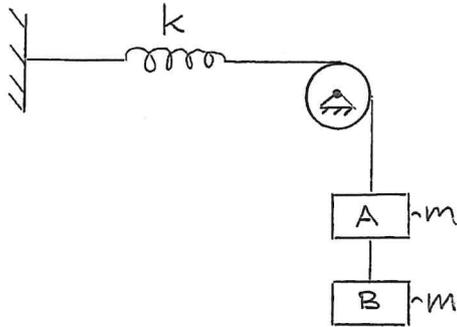
Systemet i figuren består av en fjäder, styvhet  $k$ , och två kroppar A och B med massa  $m$  vardera. Systemet är i vila då plötsligt kropp B lossnar.
