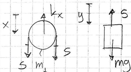
Här mäts  $x$  och  $y$  från läget med ospänd fjäder.
