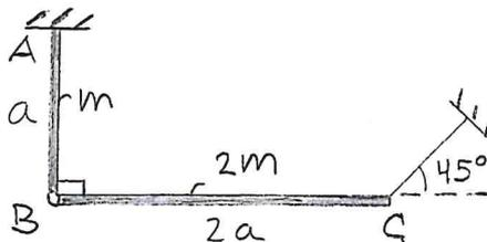
En struktur i jämvikt är sammansatt av två stänger, AB med massa  $m$  och längd  $a$ , samt BC med massa  $2m$  och längd  $2a$ . Strukturen är fast inspänd i A, friktionsfritt ledad i B och fäst i en lina i C.
