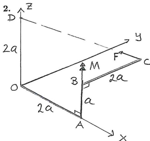
Figuren visar en masslös stång med längd  $5a$ . Delen AB är parallell med  $z$ -axeln, medan BC är parallell med  $y$ -axeln. En kraft  $F$  verkar i C, riktad mot punkten D på  $z$ -axeln. Det rena momentet verkar som synes i B och har beloppet  $M = Fa$ .
