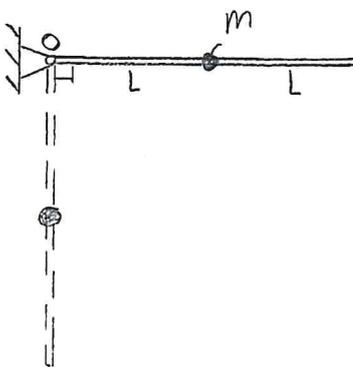
Mitt på en stång, massa  $m$  och längd  $2L$ , är en partikel med massa  $m$  fäst. Systemet släpps från vila i figurläget då stången är horisontell. Stången passerar därefter det vertikala läget. Bestäm i detta senare läge
