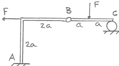
En böjd balk AB, längd  $4a$ , är fast inspänd i A och förbunden med en horisontell balk BC, längd  $2a$ , via leden i B. Två krafter  $F$  verkar på strukturen enligt figuren. Systemet är masslöst och i jämvikt.
