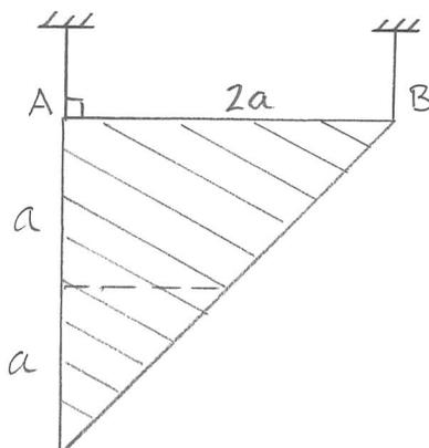
En homogen triangulär skiva med massa  $m$  har kantlängder  $2a$ . Skivan hänger i jämvikt med vertikala linor i A och B.
