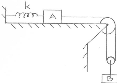
Systemet i figuren består av två kroppar A och B med massor  $m$  och  $3m$  förenade via lätta linor och trissor. En fjäder  $k$  fäster i A enligt figur. Det råder friktion,  $\mu$ , mellan A och underlaget. Systemet släpps från vila då fjädern är ospänd. Bestäm A:s största hastighet därefter (påbörjad rörelse förutsätts). (5 poäng)
