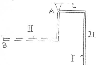
Figuren visar en böjd balk, massa  $m$  och längd  $3L$ , som kan rotera i ett vertikallplan kring friktionsfria leden A. Kroppen släpps från vila då balkdelen med längd  $L$  är horisontell (figur I).
