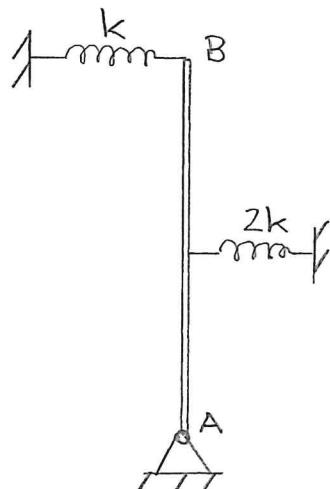
En stång  $AB$ , massa  $m$  och längd  $L$ , kan rotera kring  $A$ . En fjäder med styvhets  $k$  är fäst i toppen, medan en fjäder med styvhets  $2k$  är fäst mitt på stången. Fjädrarna är ospända i figurläget.
