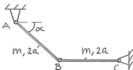
En balk AB, massa  $m$  och längd  $2a$  och lutningsvinkel  $\alpha$ , är förbunden med en likadan horisontell balk BC via ledet i B enligt figur. Systemet är i jämvikt.
