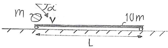
En kropp med massa  $m$  faller in med farten  $v$ , vinkeln  $\alpha = 45^\circ$ , mot en lättörlig vagn. Vagnen har massa  $10m$  och är initialt i vila. Föremålet glider under friktion och lämnar slutligen vagnens högra ände med farten  $v/2$  relativt vagnen. Bestäm härur friktionsskriftens arbete. (5 poäng)
