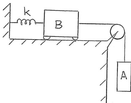
En hängande kropp A, massa  $m$ , är förbunden med en kropp B, massa  $2m$ , via en lina som löper över en masslös trissa. Kropp B är i sin tur förbunden med en fjäder, styvhet  $k$  enligt figur. Systemet är från början i jämvikt.
