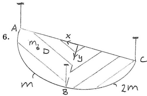
En halvcirkelskiva med radie  $R$  består av två lika stora delar med olika massor enligt figur ( $m$  respektive  $2m$ ). Skivan hålls horisontell via tre vertikala linor fästade i  $A$ ,  $B$  och  $C$ . En partikel med massa  $m$  skall placeras i en punkt  $D$  så att de tre linkrafterna är lika stora. Bestäm läget för  $D$ , d.v.s.  $(x_D, y_D)$ . (5 poäng)
