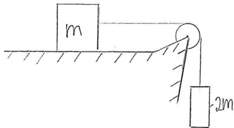
En hängande kropp, massa  $2m$ , är förbunden med en låda, massa  $m$ . Lådan är på ett strävt underlag, friktionskoefficient  $\mu = 0.5$  ( $\mu = \mu_s = \mu_k$ ). Systemet släpps från vila. Bestäm för den hängande massan
