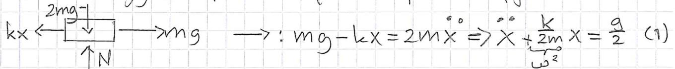
$$(1) \text{ lösning } X = X_h + X_p = A \sin(\omega t) + B \cos(\omega t) + \frac{g}{2\omega^2} \quad (2)$$
