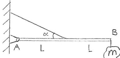
En masslös balk AB med längd  $2L$  uppbar en massa  $m$  i sin högra ände. Mitt på balken fäster en lina med lutningsvinkel  $\alpha$  enligt figur.
