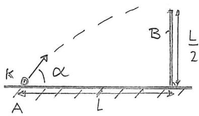
Ett föremål  $K$  (partikel) slängs iväg från  $A$  med elevationsvinkeln  $\alpha = 45^\circ$ , varvid  $K$  nätt och jämt når över muren  $B$  enligt figur. Om föremålet istället slängs med samma fart men med elevationsvinkeln  $\alpha = 60^\circ$ , hur långt ovanför muren passerar då  $K$ ? (5 poäng)
