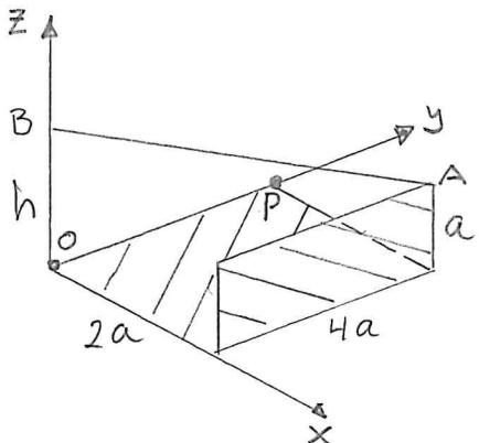
En rektangulär skiva med massa  $m$  är böjd enligt figur. Skivan är lagrad i kulleder i  $O$  och  $P$ . För att möjliggöra jämvikt så är en lina fäst i skivans ena hörn  $A$ , samt rakt ovanför  $O$  i punkten  $B$ . Bestäm minsta möjliga avstånd  $h$  (mellan  $O$  och  $B$ ) så att linkraften inte överskridar  $mg$ . (5 poäng)
