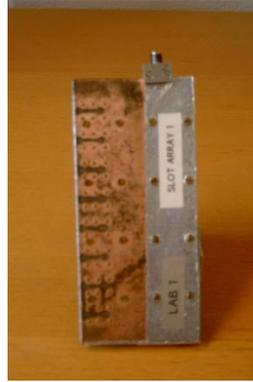
Microstrip slot array antenna
