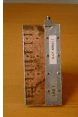
Microstrip slot array antenna
