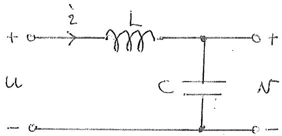
a) Visa att om spänningen över kapacitansen C och strömmen genom induktansen L väljs som tillståndsstorheter erhålls följande tillståndsekvation, där pålagd spänning u är insignal:
