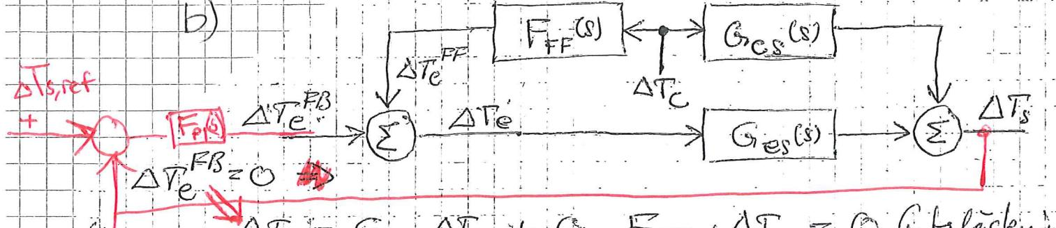
$$\Delta T_s = G_{CS}(s) \Delta T_c + G_{ES}(s) F_{FF} \cdot \Delta T_c = 0 \text{ (utsläckning)}$$
