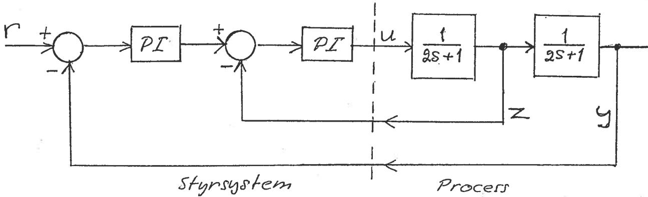
En process kan betraktas som två seriekopplade 1:a ordningens system, där såväl utsignalen  $y$  liksom en mellanliggande variabel  $z$  är tillgängliga för mätning. Ovanstående figur indikerar att reglersystemet är av kaskadtyp, och utrustat med två PI-regulatorer. Återkopplade systemet skall ha följande egenskaper:
