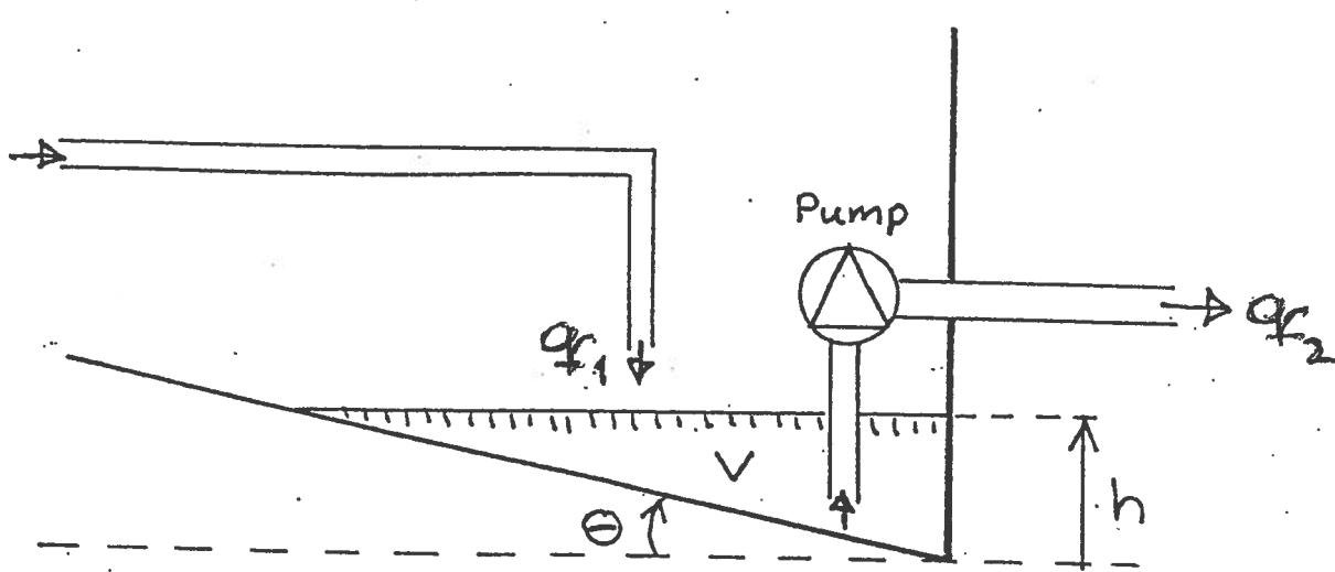
Systemets (enda) tillståndsstorhet är vattenvolymen i rännan,  $V$  ( $\text{m}^3$ ). Instorheter är flödet till rännan,  $q_1$  ( $\text{m}^3/\text{s}$ ) och pumpflödet från rännan,  $q_2$  ( $\text{m}^3/\text{s}$ ). Nivån i rännan,  $h$  (m), är utstorhet. Uppställ en överföringsfunktion  $G(s)$ , som relaterar avvikelser i pumpflödet till nivåavvikelse, då den stationära volymen antages vara  $V_0$  (dvs från  $\Delta q_2$  till  $\Delta h$ ).
