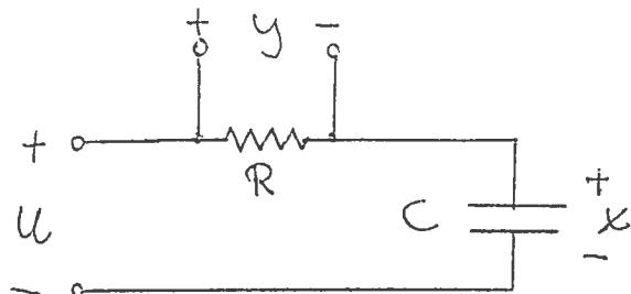
Systemets insignal är pålagd spänning  $u$  och dess utsignal är spänningen  $y$  över resistansen  $R$ . Som tillståndsstorhet har valts spänningen  $x$  över kapacitansen  $C$ .
