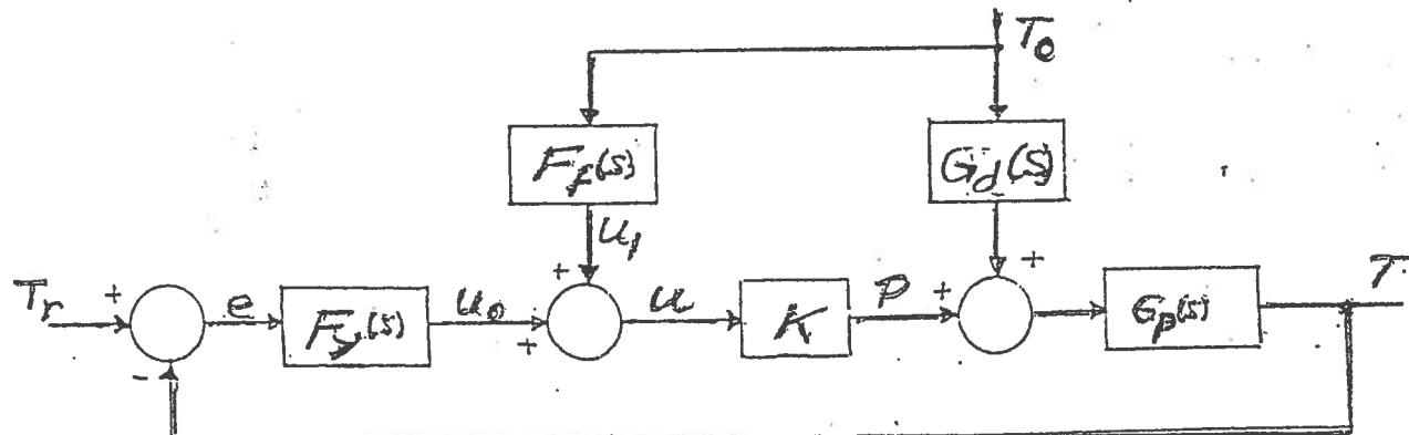
Bestäm överföringsfunktionerna  $G_p(s)$ ,  $G_d(s)$  i ovanstående blockdiagram, och bestäm framkopplingsfiltret  $F_f(s)$ , så att inverkan av variationer i tillflödestemperaturen  $T_0$  fullständigt elimineras. Observera speciellt att beräkning av regulatorn  $F_y(s)$  inte ingår i uppgiften!
