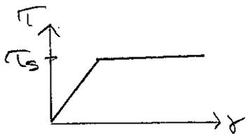
$$(3) \text{ ger då } \varphi = \frac{M_{v,s} \cdot 2L}{G \cdot 2\pi R^3 t} = \frac{2\tau_s L}{GR} \approx 25,97 \cdot 10^{-3} \text{ rad} \approx \underline{\underline{1,49^\circ}}$$
