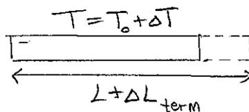
$$\Delta L = \alpha \Delta T L, \quad \alpha = \text{längdutvidgningskoeff.}$$
