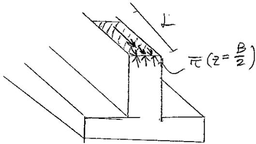
Skjuvkraft längs en sträcka L i x-led:
