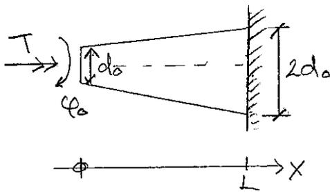
$d(x) = d_0 \left(1 + \frac{x}{L}\right)$ , Massivt tvärsnitt.
