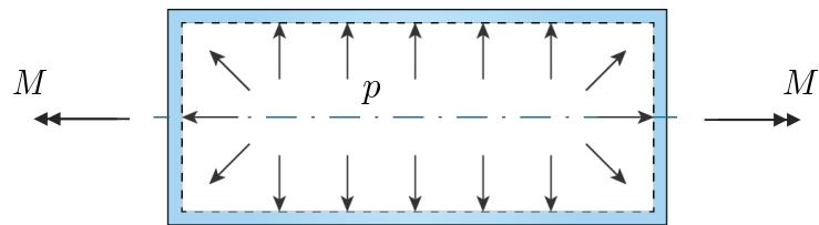
bestäm största  $M$  så att von Mises effektivspänning i cylinderns mantelyta inte överskrider 200 MPa.
