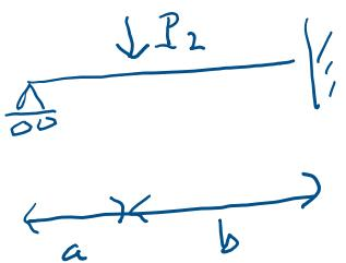
eftersom spegelvänd  $b = \alpha L$ ,  $a = (1-\alpha)L \Rightarrow$  utböjning vid lasten
