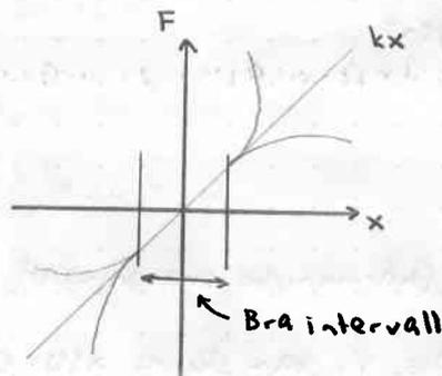
Grafen åskådliggör att fjäderkonstanten multiplicerad med fjäderns förlängning, ändras linjärt på ett litet intervall kring jämviktsläget. Vi idealiserar.
