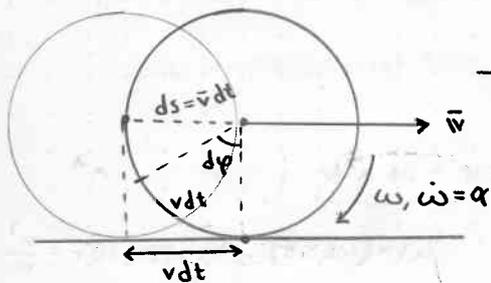
Vi ser att  $r d\varphi = v dt$  ty sträckan som rullat i marken på cylindern måste sammanfalla med marksträckan
