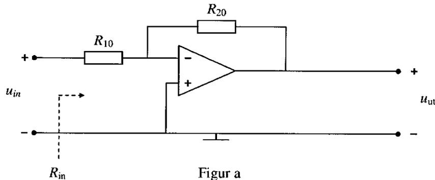
Då blir  $R_{in}=R_{10}$  som väljs till  $1\text{ M}\Omega$  och förstärkningen  $u_{ut}/u_{in} = -R_{20}/R_{10}$  som blir det önskade värdet med  $R_{20} = 100\text{ M}\Omega$ .
