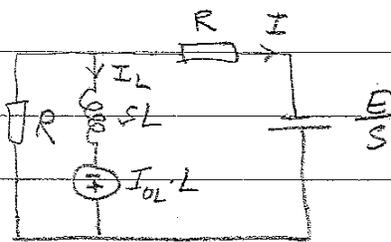
$$\begin{cases} R(I + I_L) + I_L \cdot sL - I_{OL} \cdot L = 0 & \text{KVL} & I_{OL} = \frac{E}{R} \\ R(I + I_L) + RI - \frac{E}{s} = 0 & \text{KVL} \end{cases}$$
