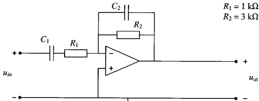
6. En förstärkare med inimpedans  $1\text{ M}\Omega$  och förstärkning  $-100$  ggr önskas. Detta kan erhållas med en enkel operationsförstärkarkoppling enligt figur a.
