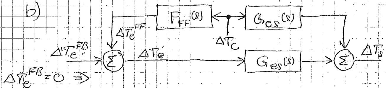
$$\Delta T_s = G_{es} \Delta T_c + G_{es} F_{FF} \cdot \Delta T_c = 0 \text{ (utsläckning)}$$
