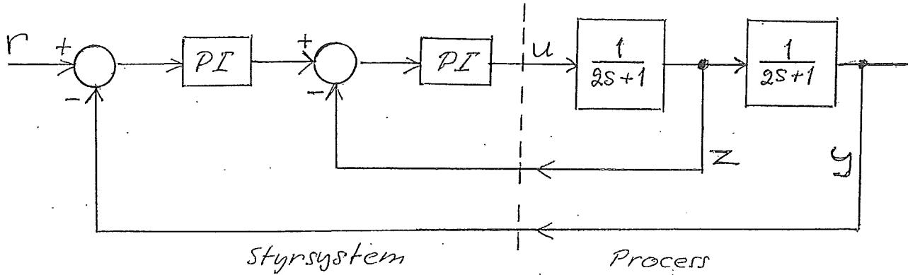
En process kan betraktas som två seriekopplade 1:a ordningens system, där såväl utsignalen  $y$  liksom en mellanliggande variabel  $z$  är tillgängliga för mätning. Figur ovan indikerar att reglersystemet är av kaskadtyp, och utrustat med två PI-regulatorer. Det återkopplade systemet skall ha följande egenskaper:
