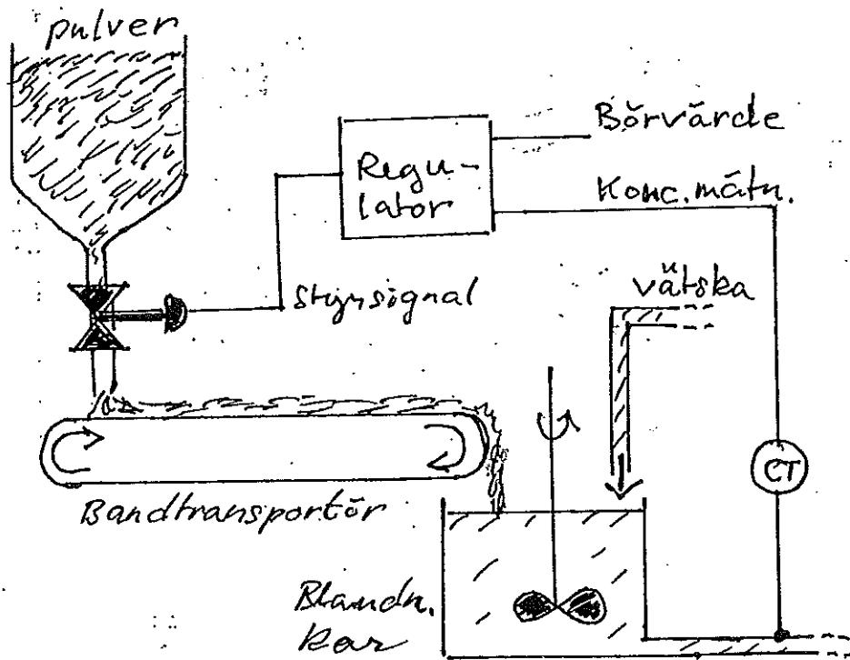
Ovanstående figur visar ett system för koncentrationsreglering. Blandningskäret matas med ett pulver av varierande sammansättning. Genom att styra matningsventilen vill man åstadkomma konstant koncentration hos den utgående blandningen. Följande överföringsfunktioner för de olika delsystemen samt PI-regulatorn kan antas (tider i minuter):
