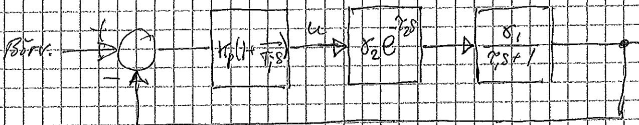
$$L(s) = \frac{K_p(T_1 s + 1)}{T_2 s} \cdot \delta_2 e^{-T_2 s} \cdot \frac{\delta_1}{s^2 + 1}$$
