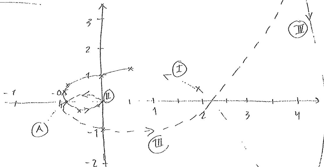
För stabilt återkopplat system krävs  $N = -2$ , dvs två moturs omvälvningar kring  $-1$ . Detta kan erhållas enl.
