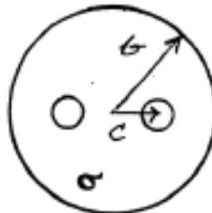
4. En enkel likströmsmotor består av ett ekerhjul med radien a och n stycken ekrar. Hjulet befinner sig i ett axiellt homogent magnetfält med styrkan  $B_0$ . Varje eker har resistansen R, medan resistanserna hos nav och periferi är försumbara. Motorn är ansluten till likspänningen  $U_0$ .
