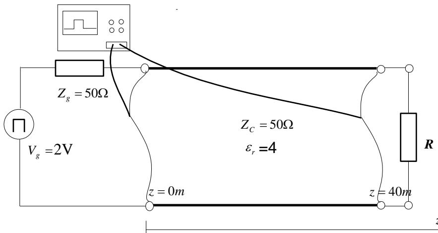
Ett oscilloskop (med oändlig impedans för att inte störa pulsutbredningen) kan anslutas för att mäta spänningen vid ingången av kabeln och vid lasten. Generatorn skickar en fyrtantig puls med amplitud 2 Volts and längd  $10^{-7}$  sekunder.
