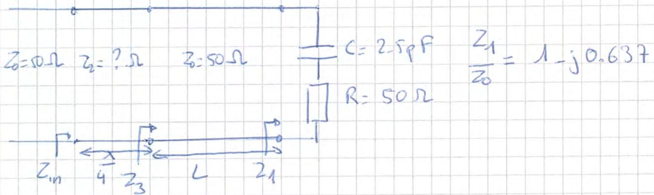
För att få  $Z_{in} = Z_0$  måste  $Z_3$  vara endirektiel. dvs  $I_m(Z_3) = 0$
