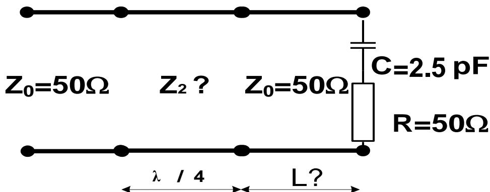
Bestäm längden  $L$  av transmissionsledningen och karakteristiska impedans  $Z_2$  av kvartsvågstransformatorn för få  $\text{VSWR}=1$  i signallinjen vid 2 GHz .
